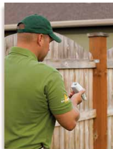
Определите наиболее подходящее место для установки датчика с помощью индикатора уровня сигнала
