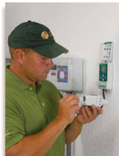
Замена батареек производится без инструментов и не требует разборки датчика
